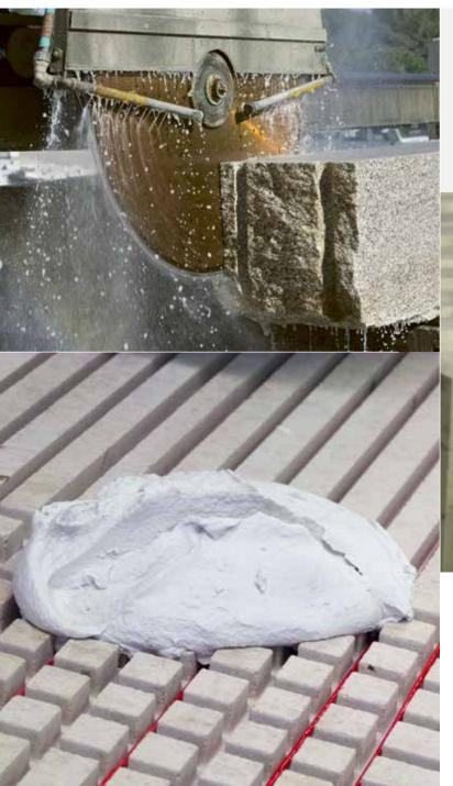
Unsere TECHNOTHERM Natursteinheizungen werden aus Natursteinblöcken unterschiedlicher Länder hergestellt. Die tonnenschweren Blöcke werden in sogenannten Gattersägen zu einem "handlichen" Maß vorgeschnitten.
